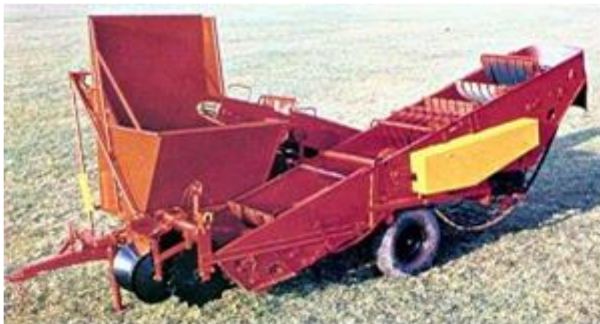
Рисунок 1.7 - Картофелеуборочный комбайн Л-601
