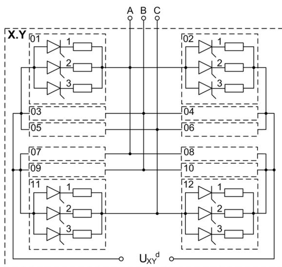
**Рис. 2.** Структурная схема унифицированного тиристорного преобразователя
