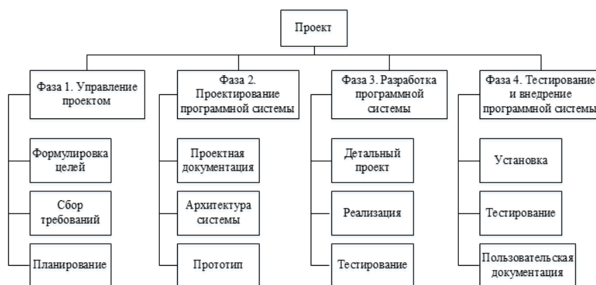
Рис. 4.1 – Иерархическая структура работ
