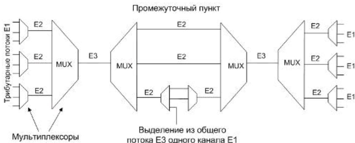
Рис. 1. Пример сети PDH с промежуточным извлечением потока E1 из основного потока E3
