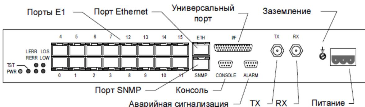
Рис. 3. Передняя панель FMUX/16E1-M-ETV
