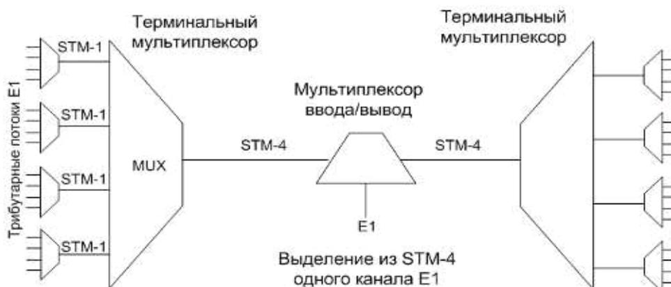
Рис. 2. SDH с промежуточным извлечением потока E1 из потока STM-4
