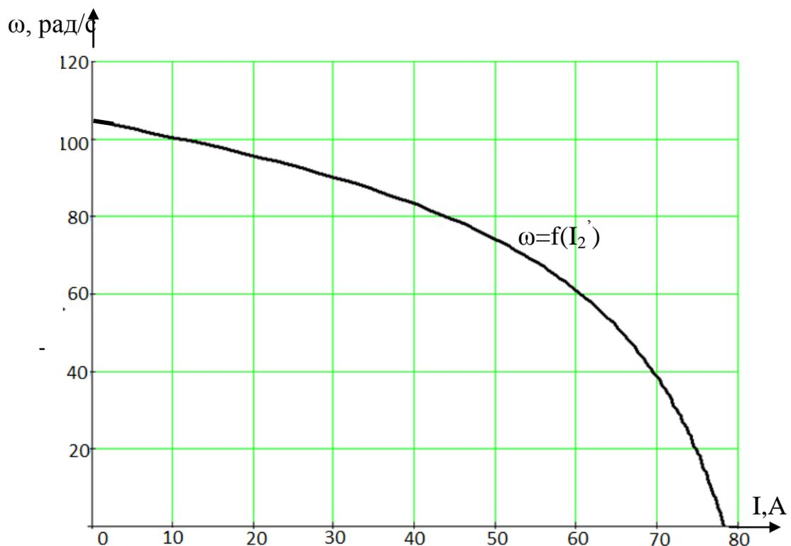
Рис. 14 Естественные электромеханические характеристики АД
