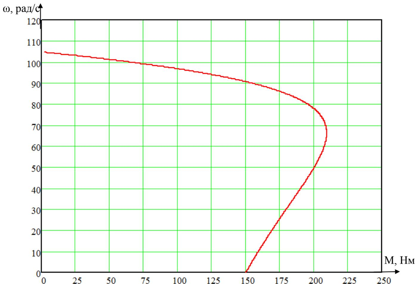
Рис.15 Естественная механическая характеристика АД
