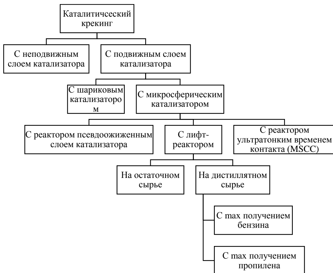
Рисунок 1.7 – Виды установок FCC
