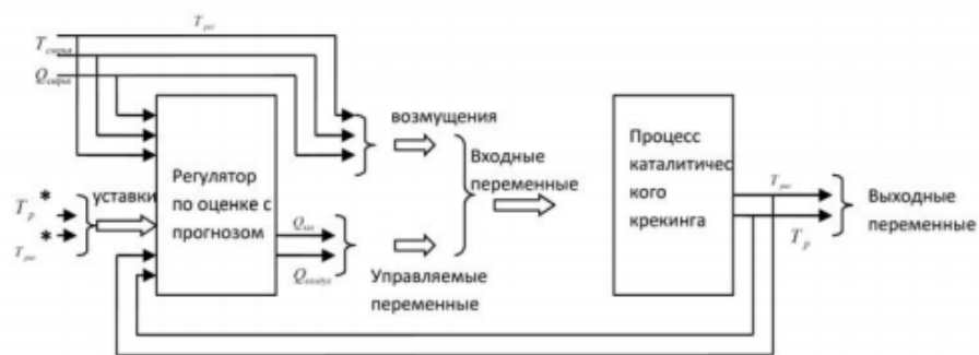
Рисунок 1.17 – Схема управления процессом каталитического крекинга нефти с использованием прогнозирующей модели
