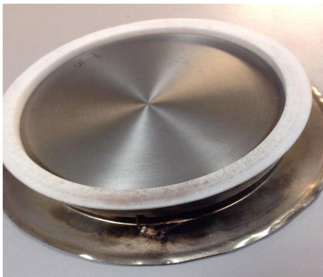
Рисунок 1.3 – Вид сгоревшего тиристора в результате пробоя
