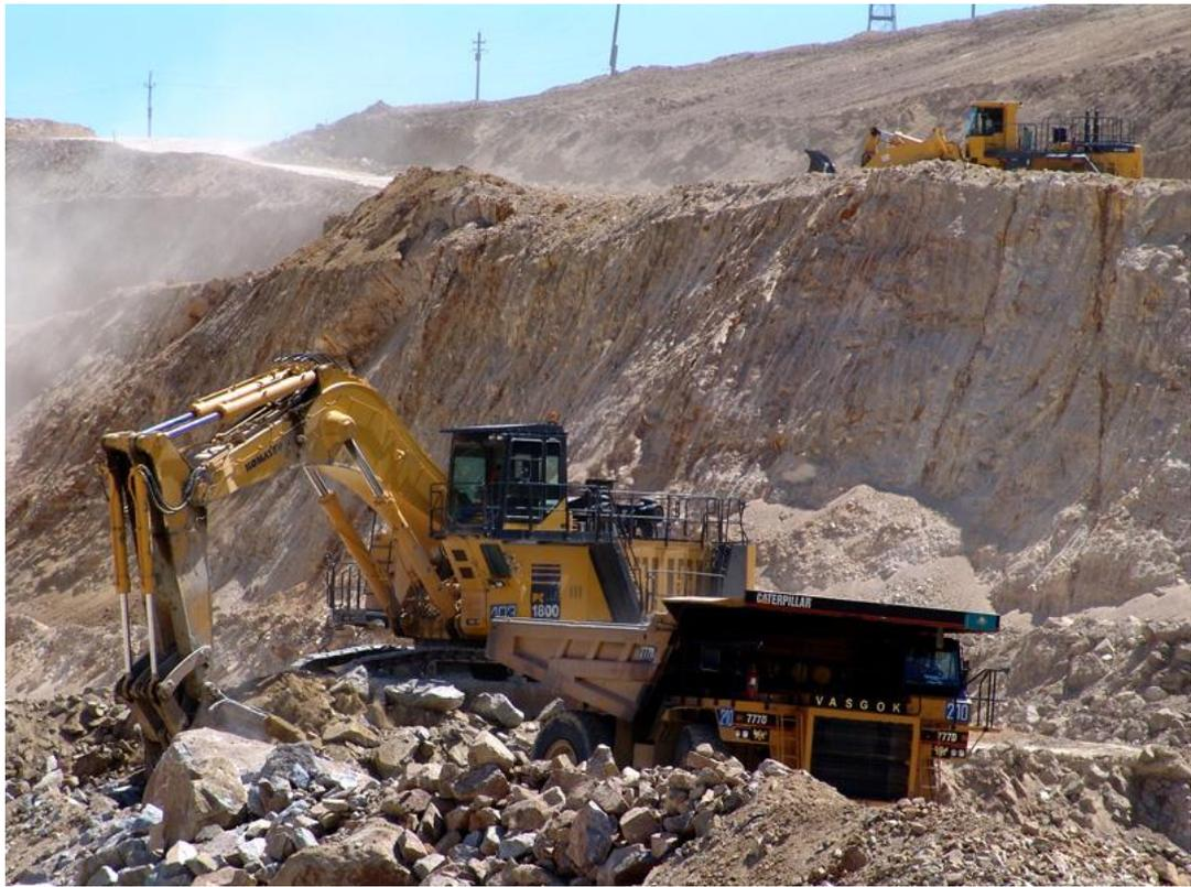
Рисунок 2 - Разработка горных пород уступами
