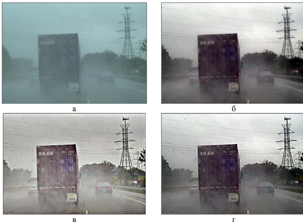
**Рис. 4.** Пример результата обработки изображения (а) с использованием предлагаемого трехэтапного способа обработки (г) и сравнение с использованием только алгоритма автонастройки уровней яркости (б) и обработкой алгоритмом MSR (в)
