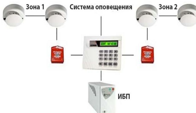
Рисунок 7 – Строение пороговой пожарной сигнализации.
