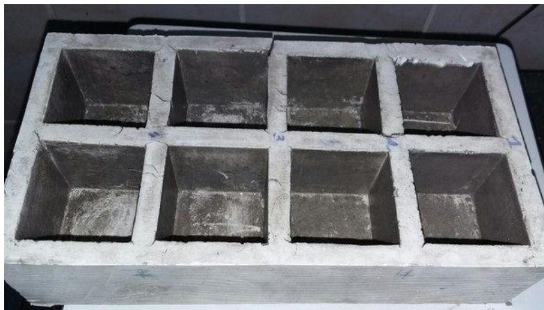
Рисунок 8 – Формы из пентапласта для отливки кубика
