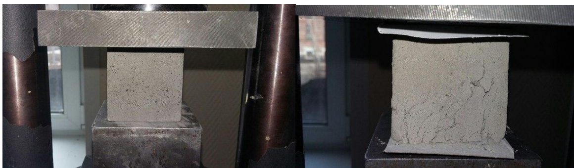
Рисунок 10 – Образцы до и после раздавливания
