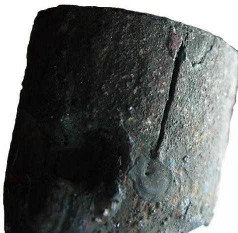
Рисунок 1.4 – Хрупкое повреждение трубы магистральной трещиной
