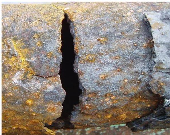
Рисунок 1.2 – Коррозионное растрескивание. Поперечный разрыв трубы пароперегревателя
