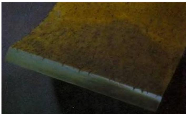
Рисунок 1.7 – Поперечные трещины вследствие усталости, начинающиеся на внутренней поверхности трубы пароперегревателя котла БКЗ-220-100-4
