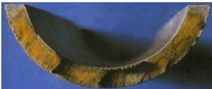
Рисунок 1.5 – Грань хрупкого излома в результате коррозионной усталости котла БКЗ-220-100-4
