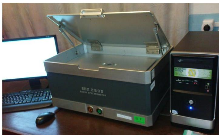
Рисунок 5.2 – Общий вид экспериментальной установки EDX 2800 EDXRF SPECTROMETER для спектрального анализа
