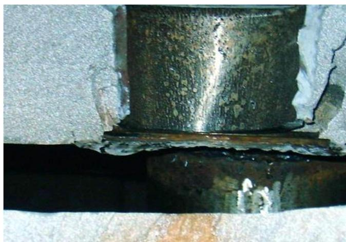
Рисунок 1.3 – Коррозионное растрескивание. Продольный разрыв барабана котла
