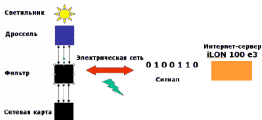
Рисунок 1.1.2.1 – Основные компоненты систем автоматизированного управления уличным освещением компании «Echelon»
