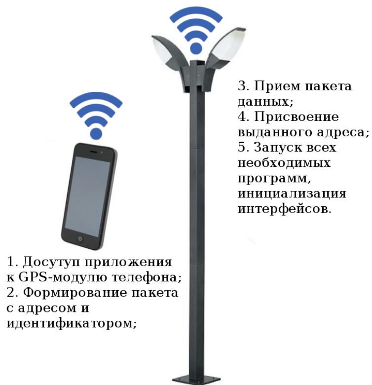
Рисунок 3.5.3 – Установка оборудования на фонарный столб
