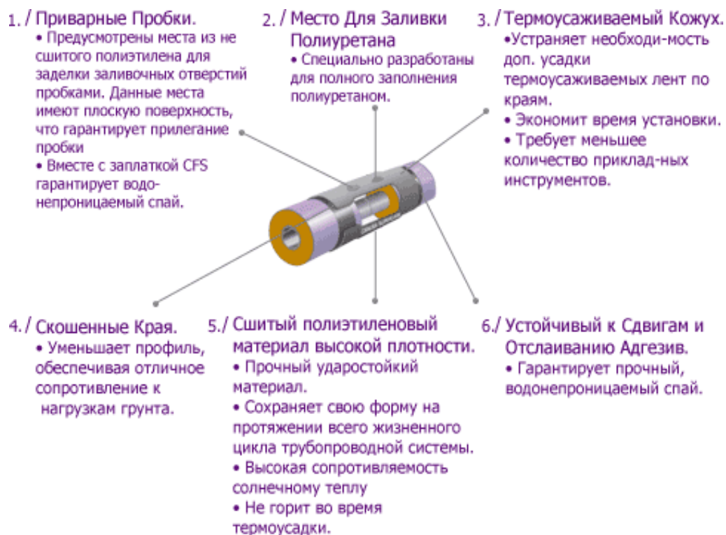
Рис. 4.12 - Схема термоусаживаемой муфты
