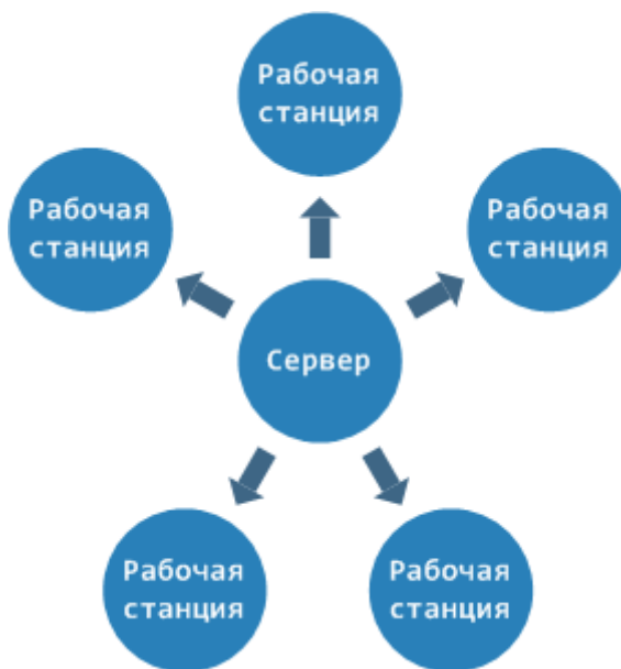
Рисунок 2 - Функциональная структура SCADA-системы «ОИК Диспетчер НТ»
