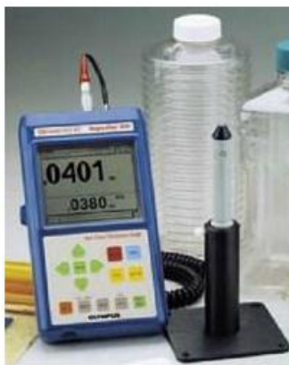
Рисунок 2.6 – Толщиномер на основе эффекта Холла Magna-Mike 8500
