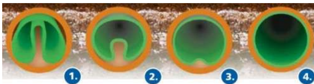
Рис.16 – Процесс «вспоминания» формы U-образной трубы
