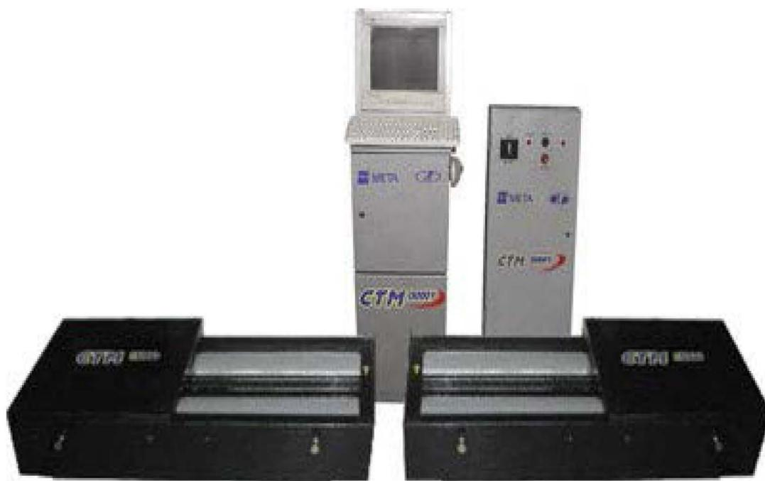
Рисунок 2.4 – тормозной стенд СТМ-15000У
