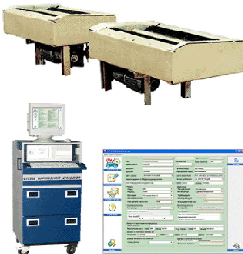
Рисунок 2.1 – Тормозной стенд СТС-13У-СП-11
