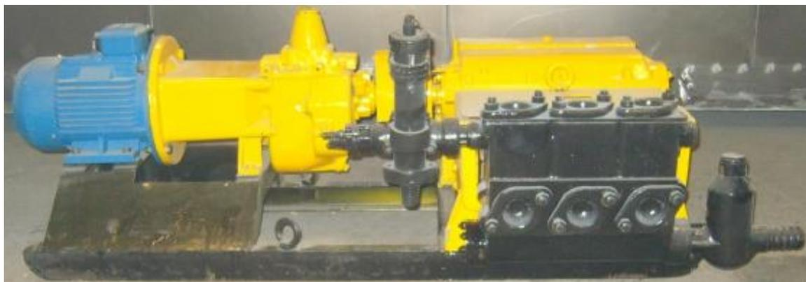
Рисунок 5.5 – Насосная установка НБЗ-120/40
