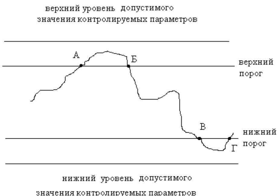
т.А, т.В - точки включения устройств управлени параметрами микроклимата.
