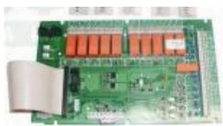
Рисунок 11 б. Плата сбора данных
