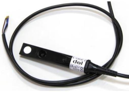
Рисунок 13 Датчик влажности DOL 114
