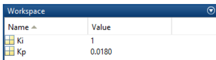
Рисунок 3.14 – Переменные K_p и K_i в рабочем пространстве Matlab Workspace
