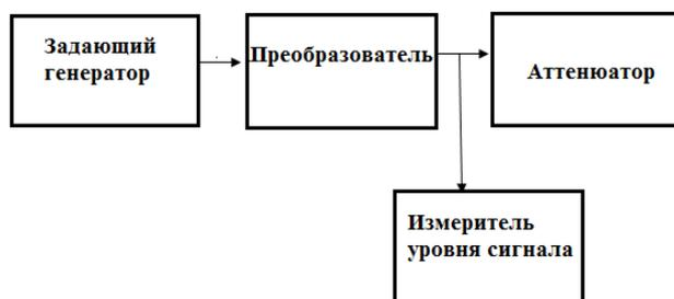
Рисунок 6 – Схема генератора шумовых сигналов
