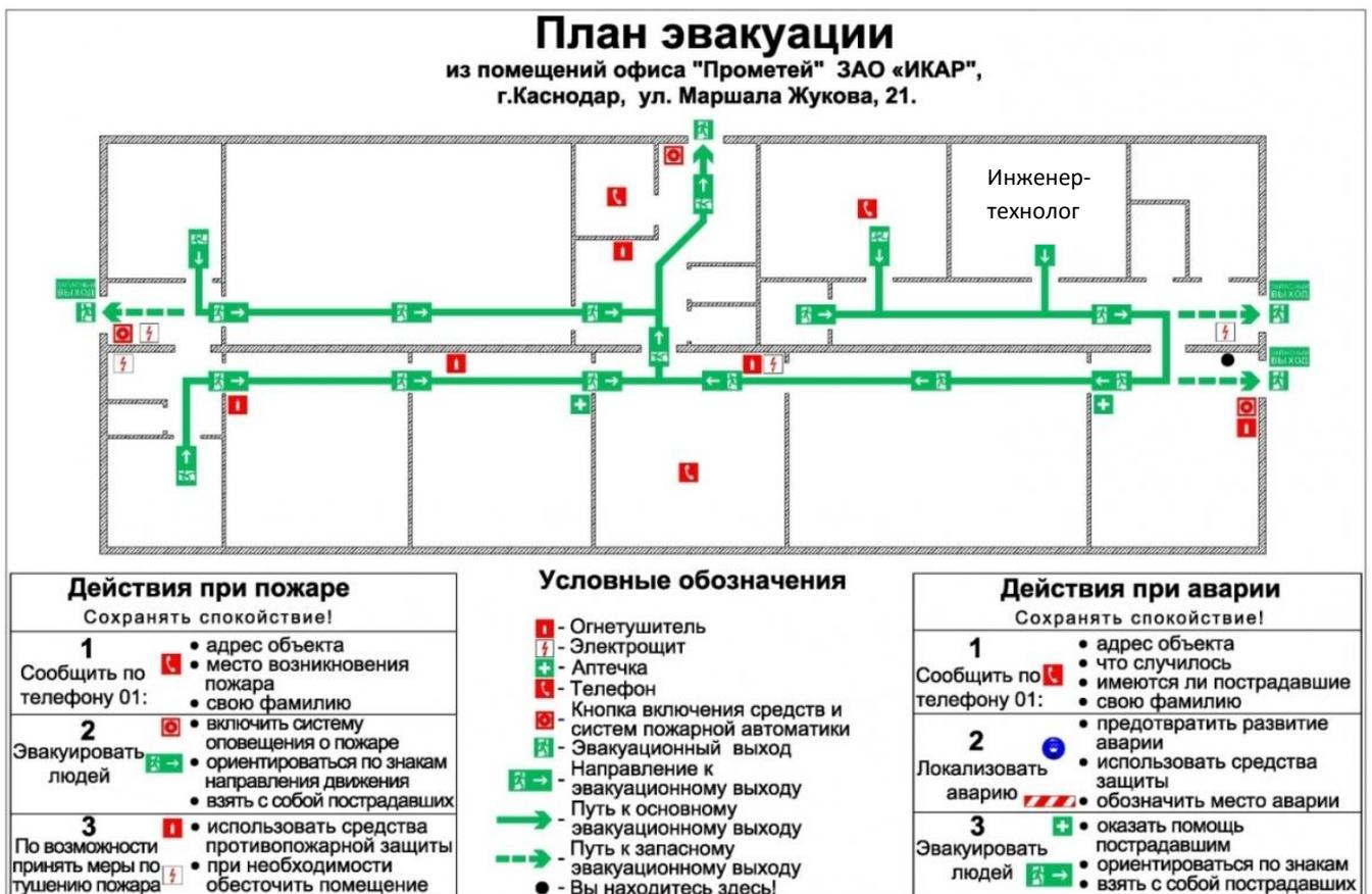
Рисунок 4. План эвакуации
