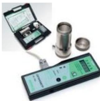
Рисунок 14 - Октанометр ПЭ-7300
