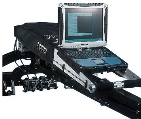
Рисунок 6 – Вихретоковый дефектоскоп Draisine 300
