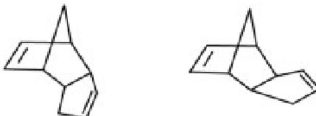
Рисунок 5 – Стере изомеры ДЦПД (экзо- и эндо-изомеры)
