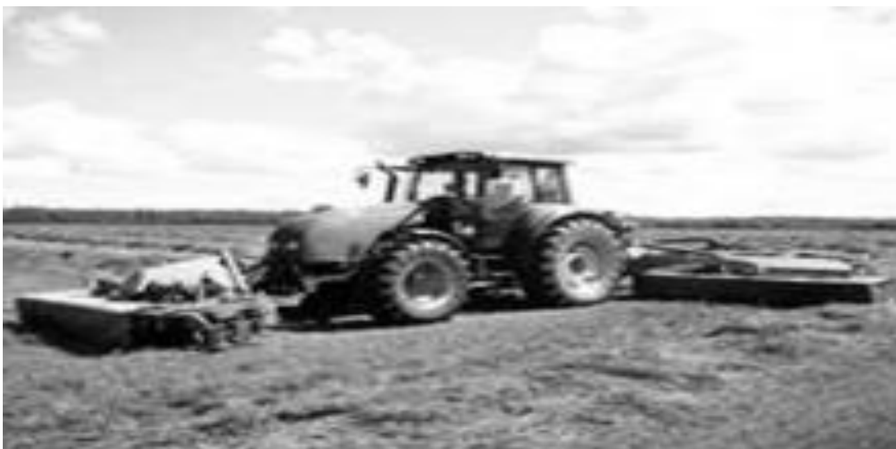
Рисунок 3.4 - Трактор VALTRA T190 с 3-х брусной косилкой DISCO 8550 AS Plus
