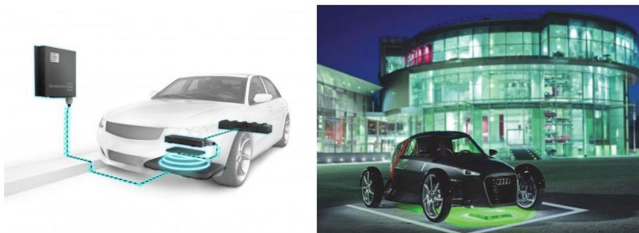
Рисунок 8 – Использование беспроводной передачи энергии в зарядке аккумуляторов автомобилей
