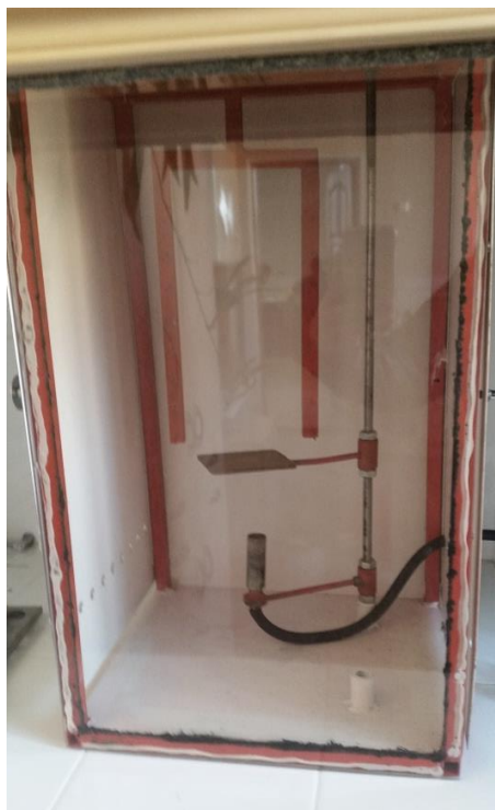
Рисунок 3.1 – Прибор для определения огнестойкости модификации ОТ-68 (ГОСТ 15898-70)
