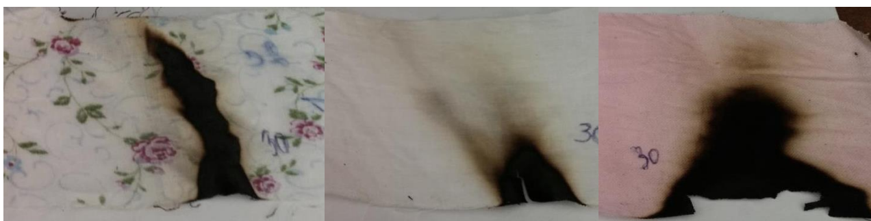
Рисунок 3.6 – Разрушение ТМ, пропитанных раствором 1, под воздействием открытого огня в течение 30 секунд
