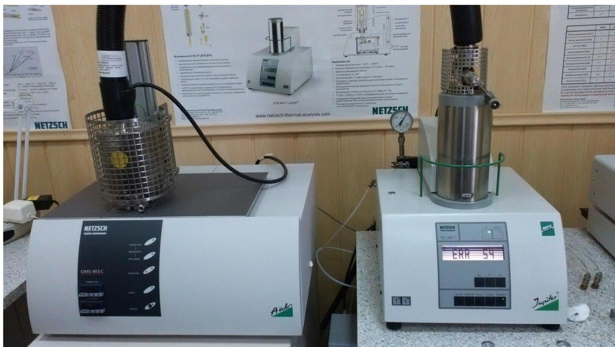
Рисунок 2.4 – Вид прибора STA 449 C Jupiter ®
