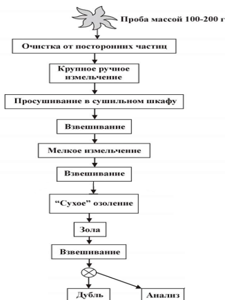
Рисунок 10 – Схема обработки и изучения проб растительности [7]
