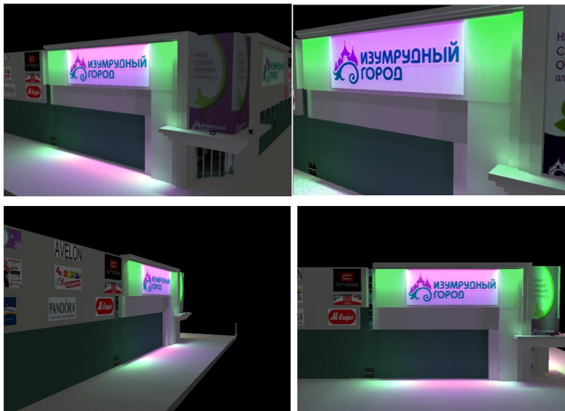
Рисунок 3.10 – Освещение ТРЦ «Изумрудный город» белыми светодиодными модулями с применением светофильтров со стороны Асфальтового переулка
