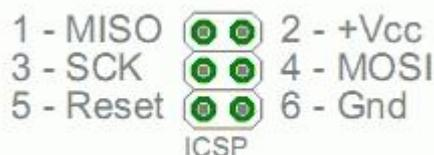
Рисунок 1.2 – разъем In-Circuit Serial Programming
