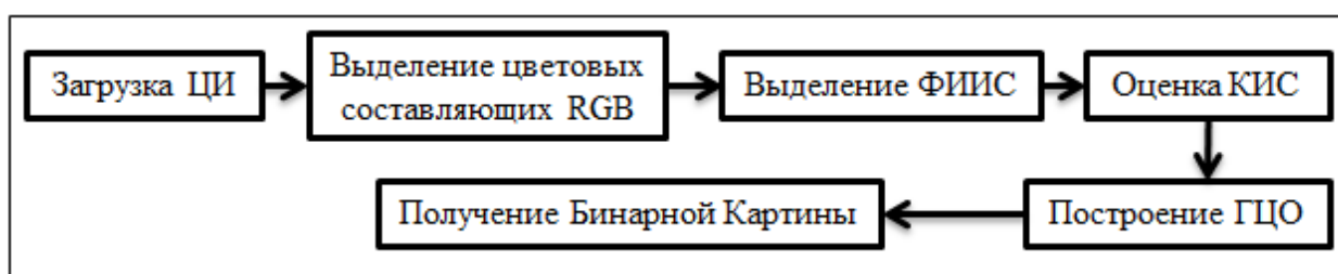
Рисунок 3.1 – Схема получения бинарного изображения индикаторного следа (ЦИ – цифровое изображение; ФИИС – фрагмент изображения индикаторного следа; КИС – контрастность индикаторного следа; ГЦО – график цветowych отклонений)
