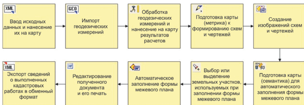
Рисунок 5.1 Схема формирования межевого плана средствами ГИС и системой автоматического заполнения форм.
