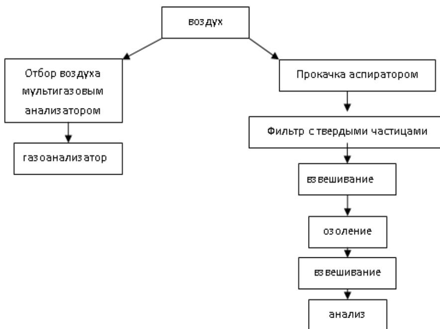
Рисунок 3 – Схема обработки проб атмосферного воздуха [17]
