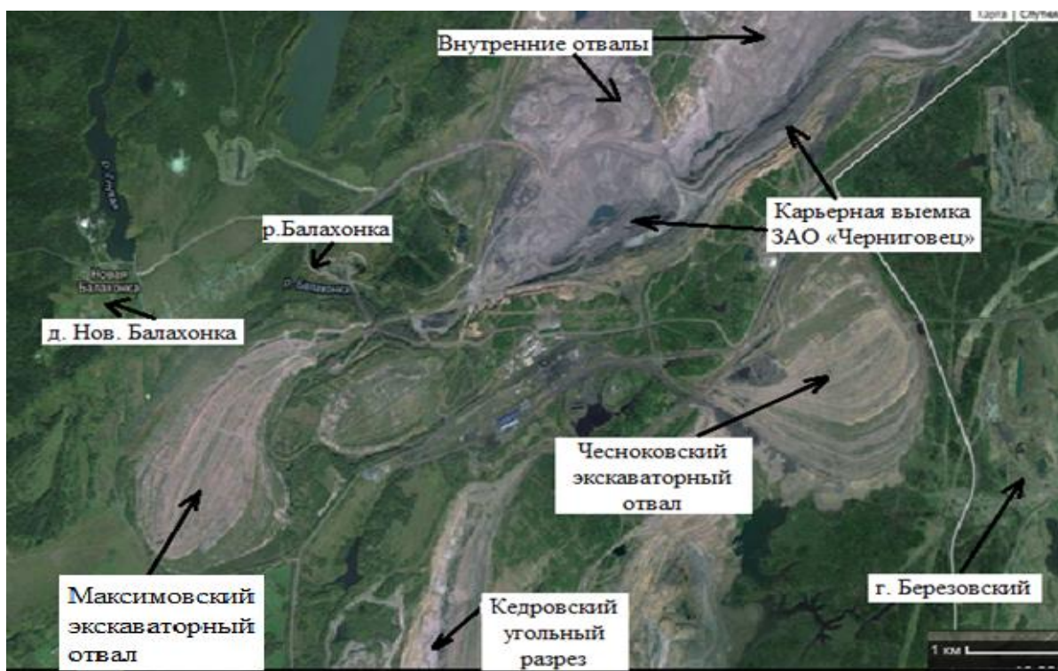
Рисунок 2 – Обзорная схема района ведения горных работ [4].
