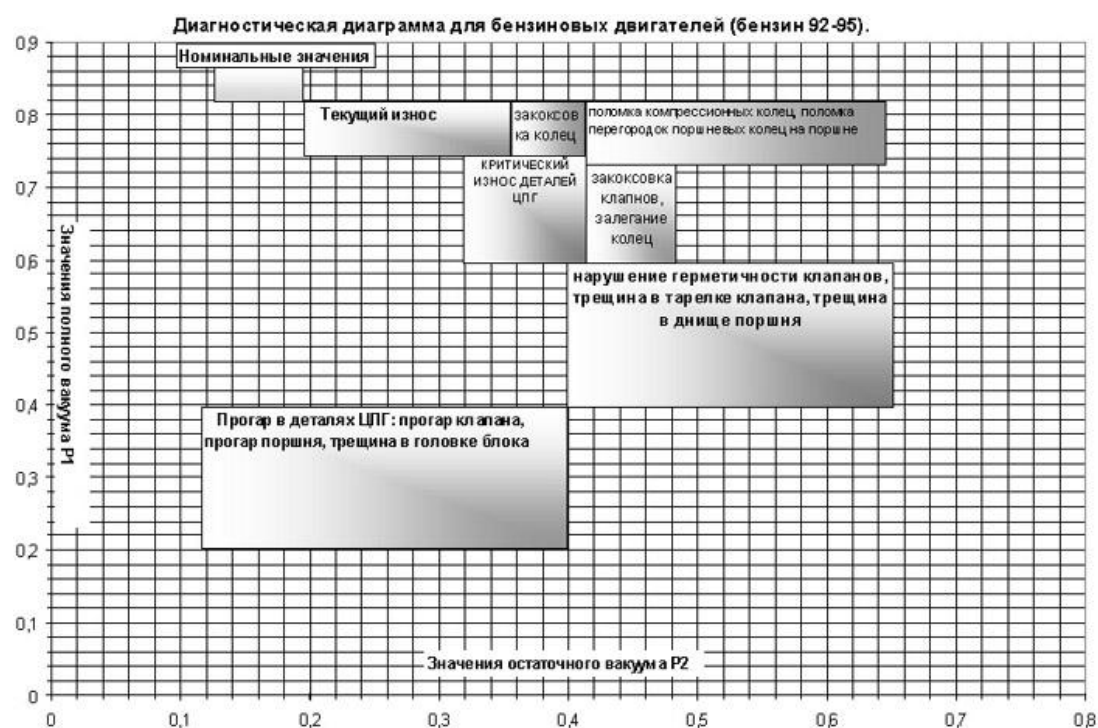
Рис. 3.7 – Диаграмма определения неисправностей для бензиновых двигателей
