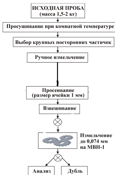
Рисунок15 - Схема обработки анализа проб почв[49]
