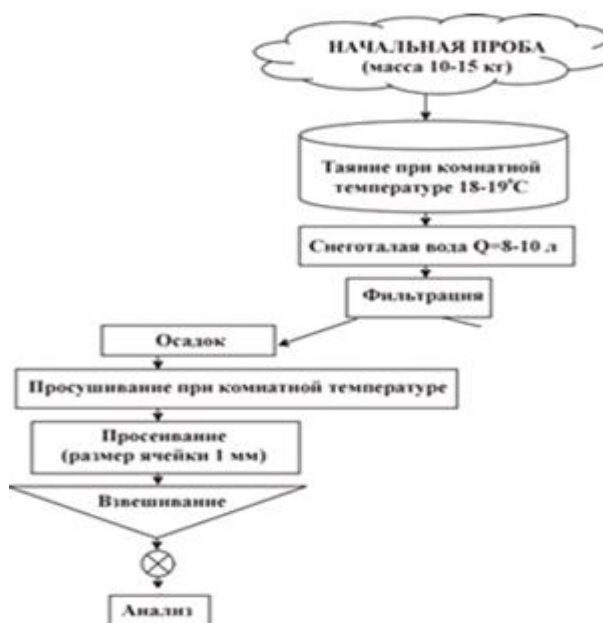
Рисунок 17 - Схема обработки и изучения проб снегового покрова [51]
