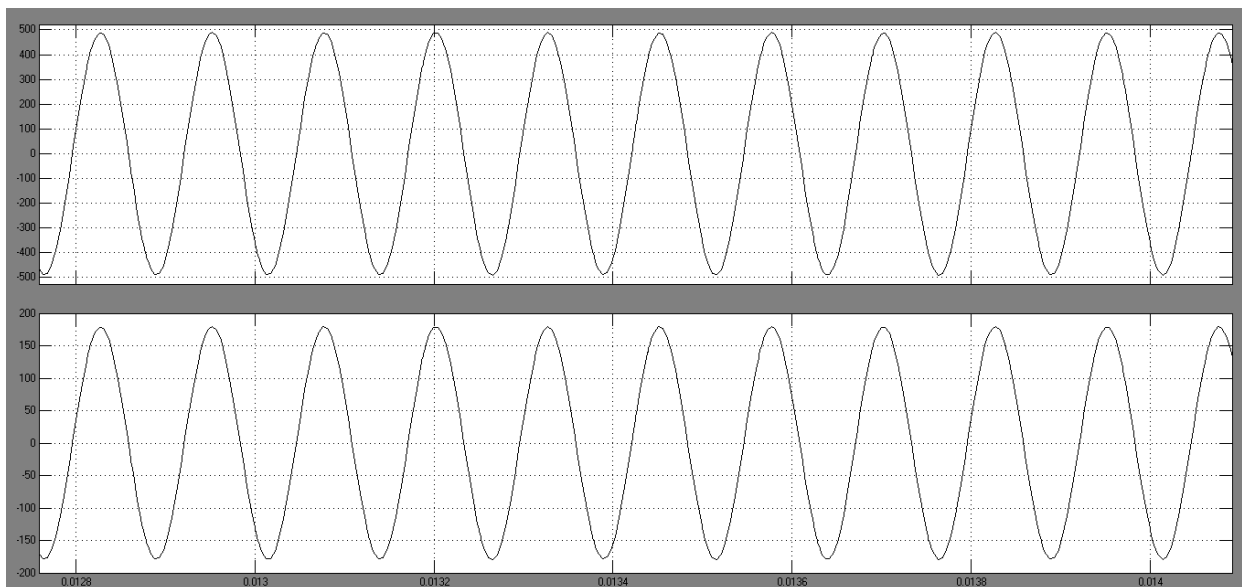
Рис. 3.15 – диаграммы напряжений и токов на индукторе без компенсирующих конденсаторов
