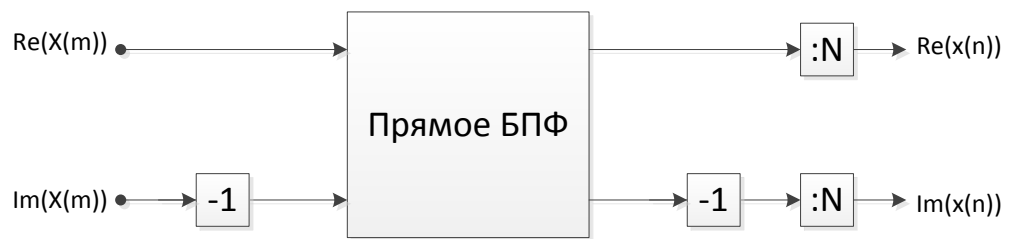
Рисунок 13 – Первая схема вычисления ОБПФ через БПФ
