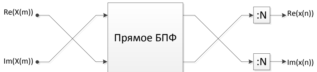
Рисунок 14 – Вторая схема вычисления ОБПФ через БПФ
