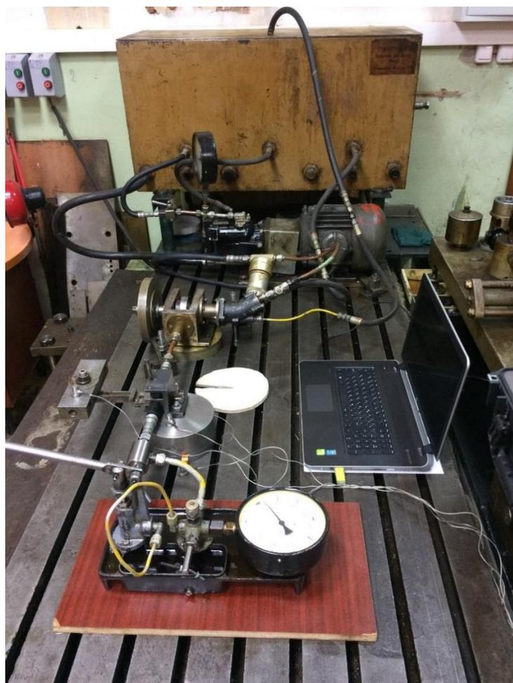
Рисунок 3.4.2.2 – Модель двухкаскадного гидропневмоамортизатора
