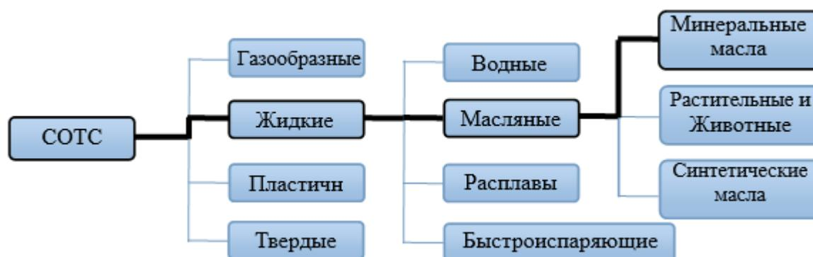
Рис.1.1. Основные типы СОТС, применяемые при резании металлов
