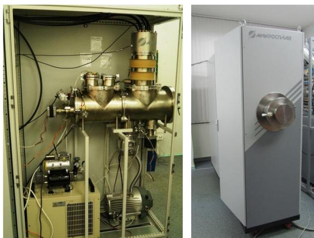
Рис.1 Внешний вид электроимпульсной установки
