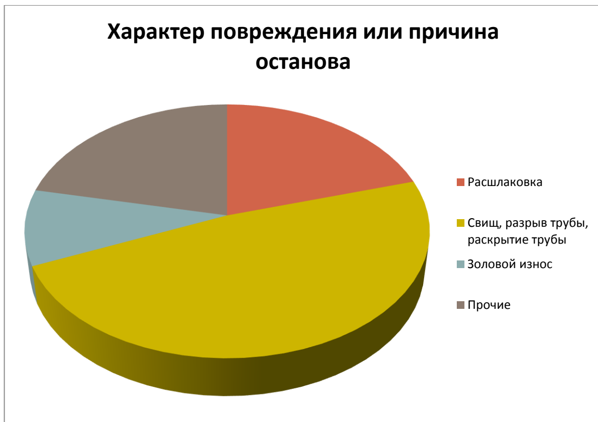
Рисунок 6 – Характер повреждений или причина останова котла
