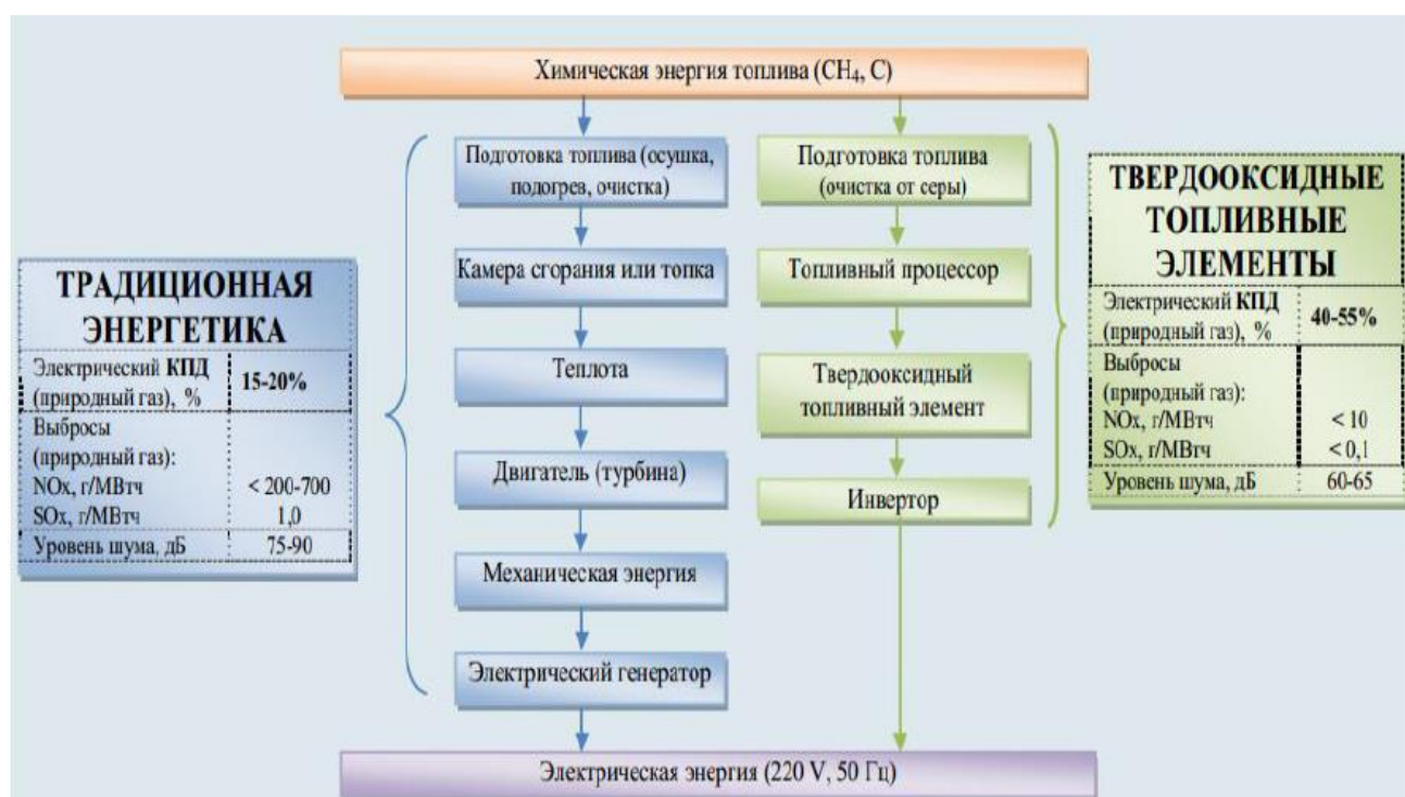
Рисунок 4.3 – Сравнение преобразования энергии топлива в электрическую энергию с применением ТОТЭ
