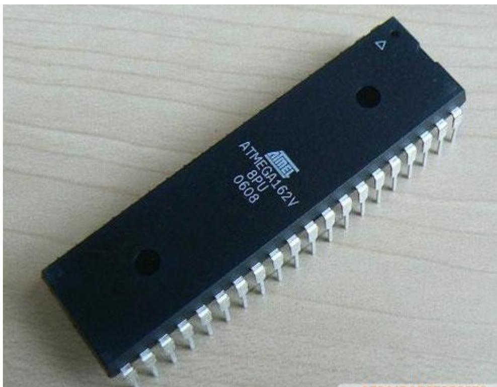
Рисунок 5 – Микроконтроллер ATMEGA 162
