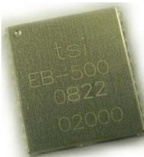
Рисунок 3 – Выбранный GPS модуль EB-500
