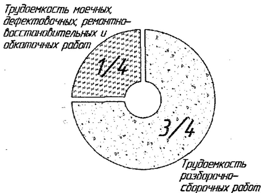
Рис. 1.6. Трудоемкость разборочно-сборочных работ КПП и раздаточных коробок грузовых автомобилей
