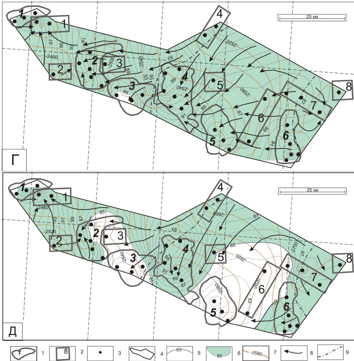
**Рис. 3.** Схемы положения очагов генерации и направлений возможной миграции баженовских нефтей 62 (А), 55 (Б), 38 (В), 5 (Г) млн л. назад и современное состояние (Д) Верхнеяминского вала: 1) – 4) то же, что на рис. 2; 5) изолинии значений температур в баженовской свите, °С; 6) контур очага генерации нефтей; 7) изогипсы кровли баженовской свиты, м; 8) направления линий тока флюидов; 9) генерализованные («талъвиговые») границы зон нефтесбора
