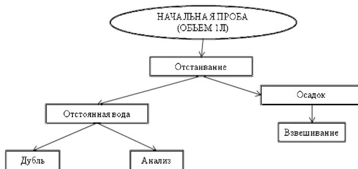
Рисунок 13. Схема обработки и анализа поверхностных проб
