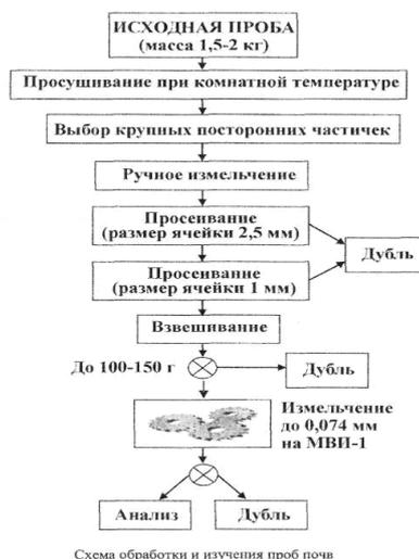
Рисунок 11. Схема обработки и изучения проб почвы
