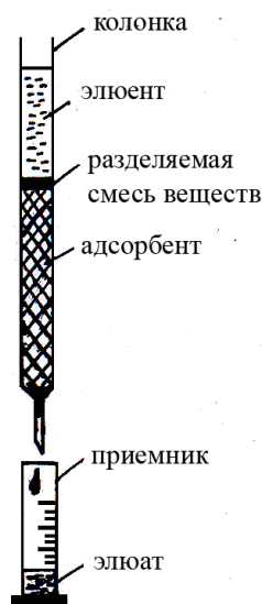
Рисунок 1 – Устройство для колоночной хроматографии [7]
